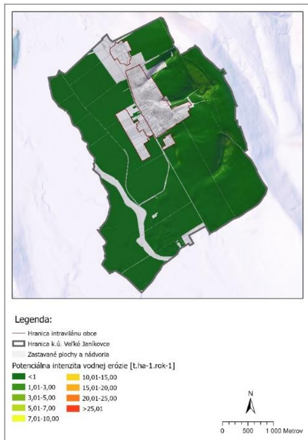
Obr. 8: Mapa vypočítanej intenzity vodnej erózie za predpokladu P=1 (vpravo) Figure 8: Map of calculated water erosion intensity when P=1 (rightside)
